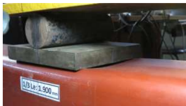
Figura 10 – Protótipo com deformações localizadas
