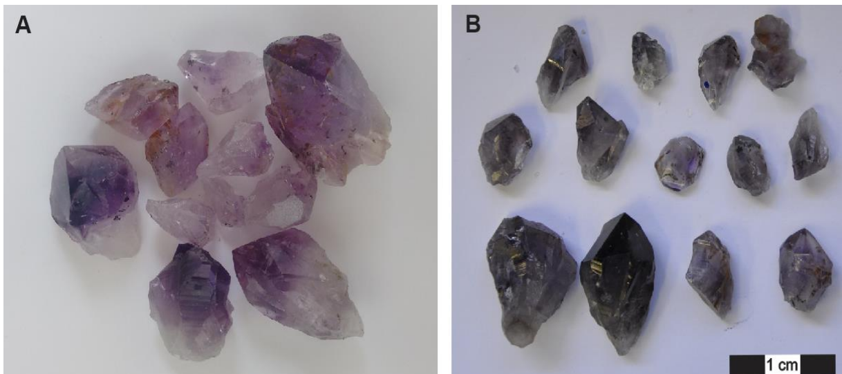
Figura 2 - Lote de amostras de ametista analisadas. A) cristais de ametista não irradiada e B) cristais de ametista irradiada com dose de 900kGy, onde observa-se a mudança de cor para violeta escura a preta.
